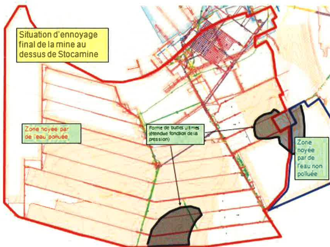
Figure 15. Etape finale de l'ennoyage du site de stockage et des vides miniers résiduels sus-jacents (document MDPa)
