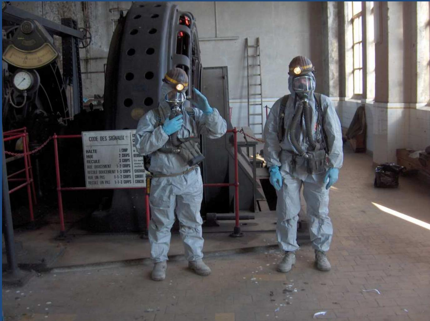
Exemple d'appareil respiratoire autonome BG174
