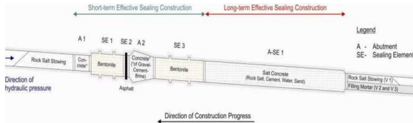
Figure 4 Principe de conception pour la construction des ouvrages d'étanchéité en galeries.
