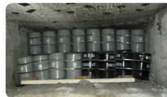
Front de déstockage de fûts arséniés.
