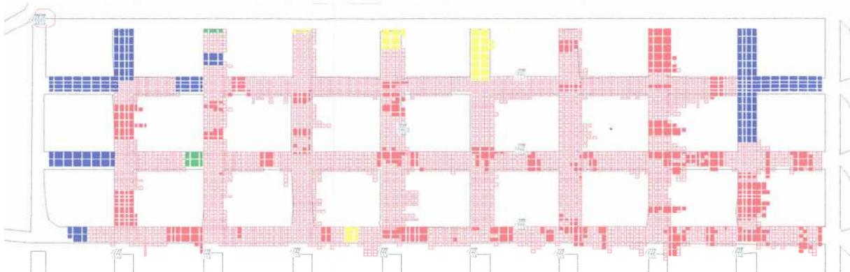
Figure 19 : Exemple de plan d'organisation des déchets dans un bloc (classement par classe).
