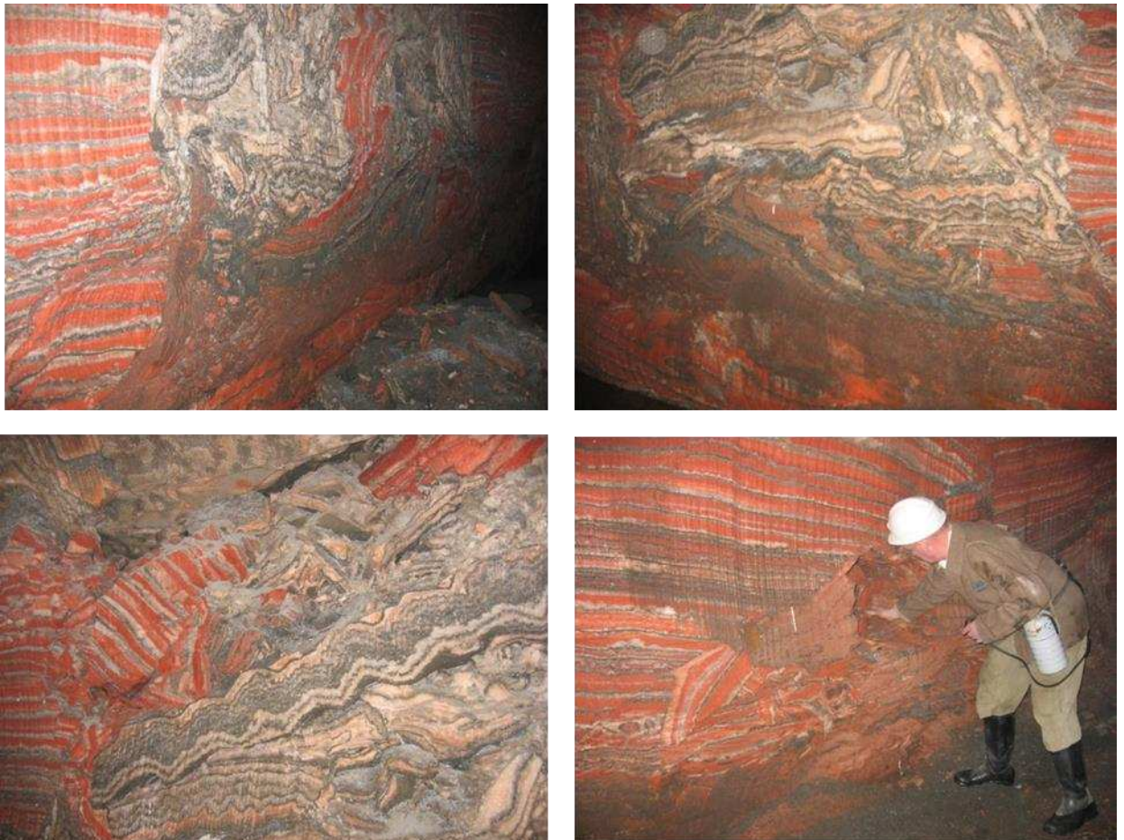
Fig. 9. Convergence d'une voie d'accès dans une couche de sylvinite : Beresniki 2 (Dr. Salzer, 19.01.2006) (dimensions initiales 3 m x 3 m)
