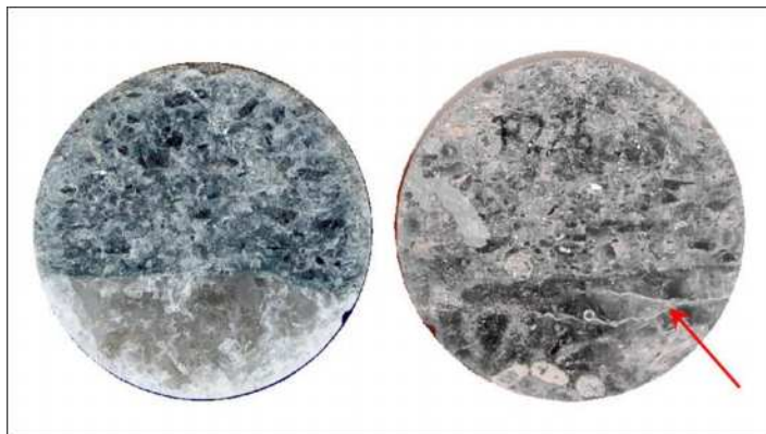
Fig. 33. Coupe du matériau (diamètre = 100 mm) au niveau de la zone de contact entre le béton de sel et le sel. La flèche désigne les contours du sel étanche
