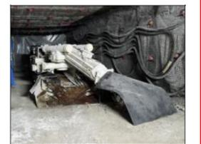
Au fond, une hâveuse permet de sécuriser les galeries et de maintenir l'accès des véhicules.
