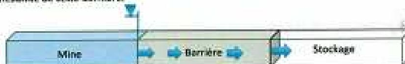
5) Les pressions hydrostatiques s'équilibrent entre la mine et le stockage.
