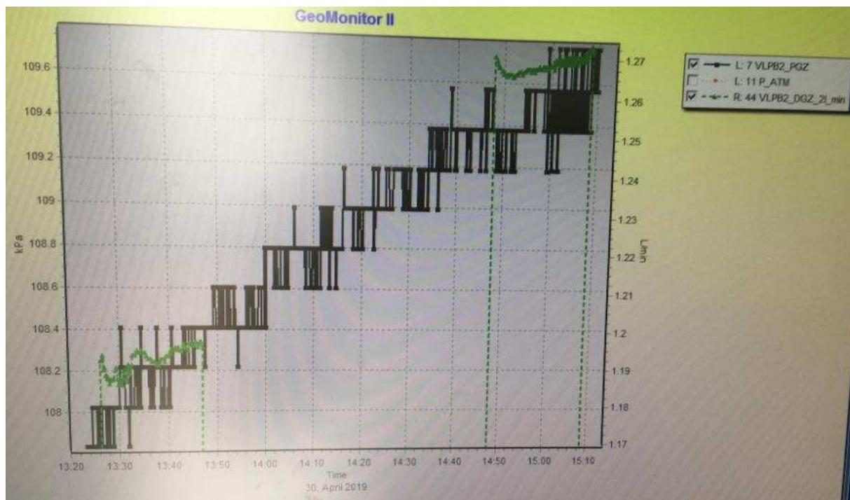
Figure 3 : suivi du débit de gaz et de la pression en tête du forage VLPB2
