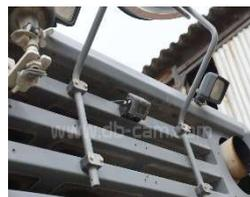
Caméra de recul intégrée à un engin de chantier
