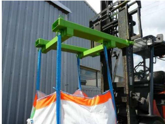
Figure 54 - Palonnier support de big bag avec prise fourche (jusqu'à 2 Tonnes)
