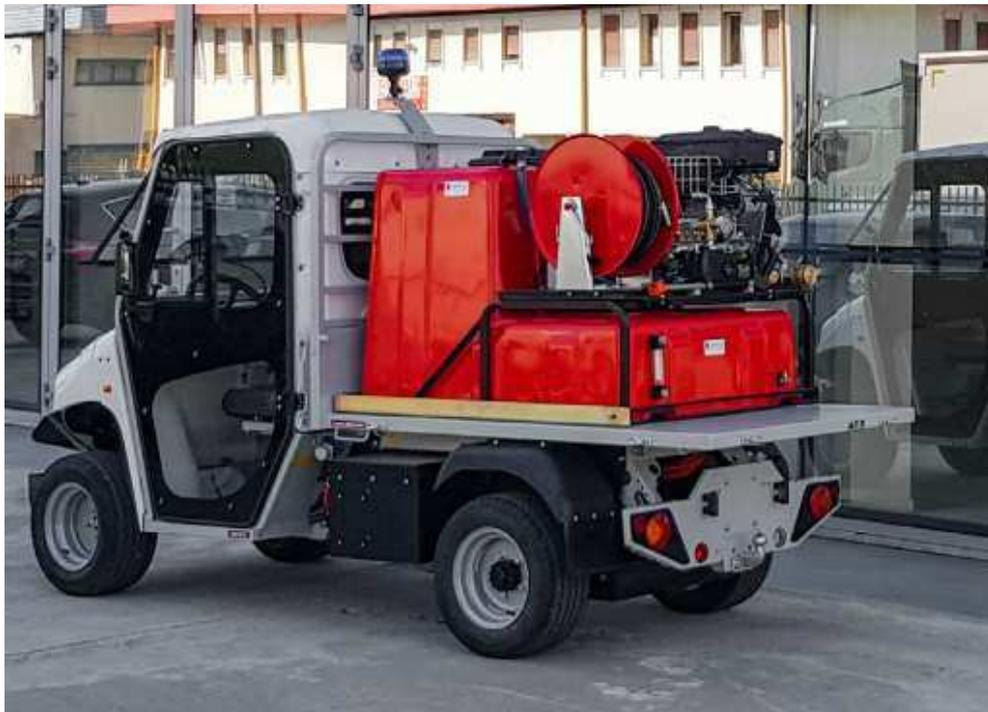
Figure 26 - Exemple de véhicule incendie sur base d'un châssis Alké
