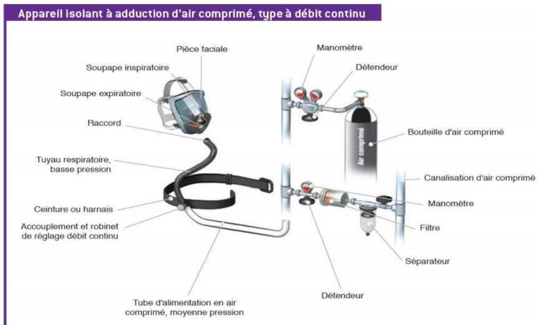
Figure 36 - Schéma d'alimentation d'un masque à partir du réseau AC
