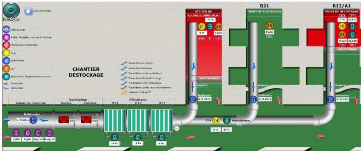
Figure 44 - Synoptique de supervision au niveau du front de déstockage
