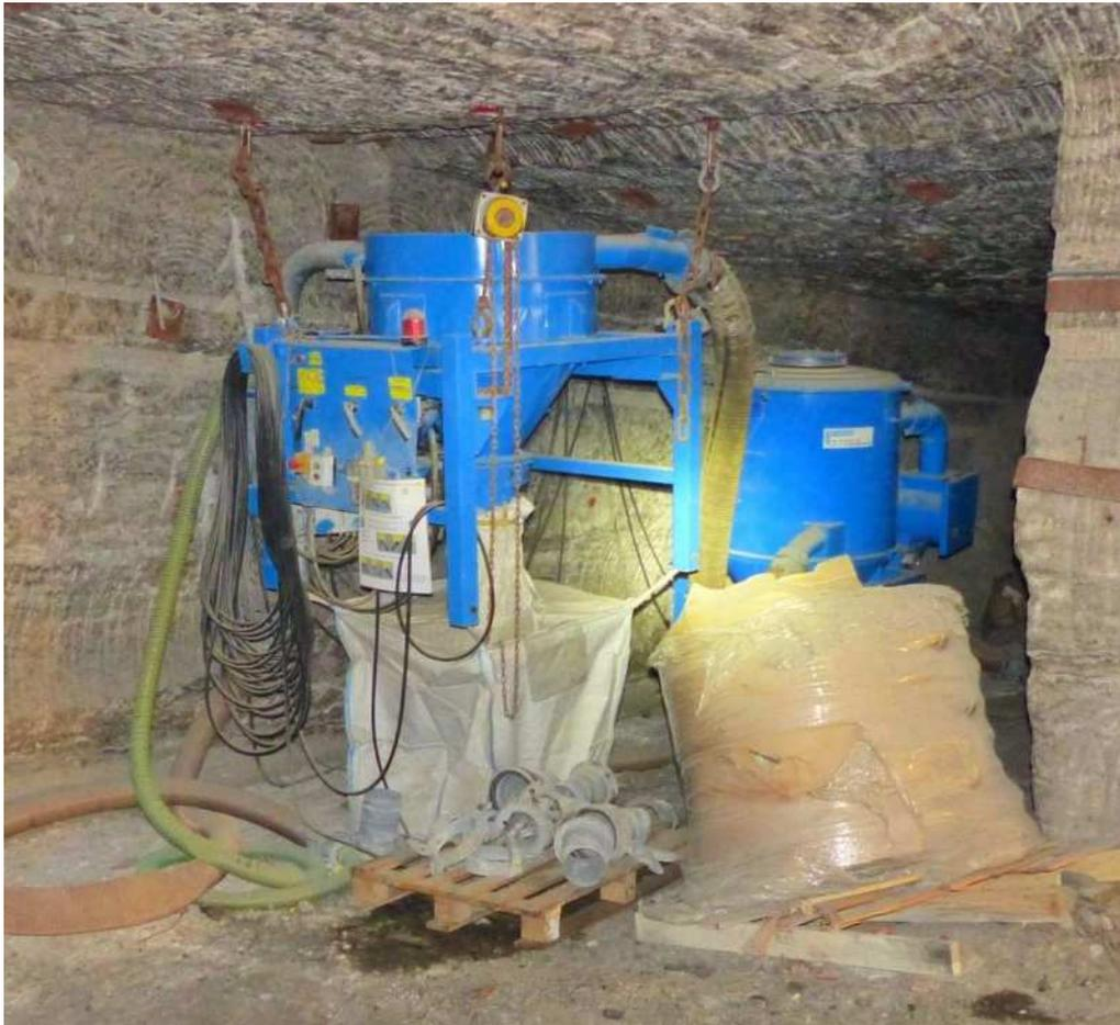
Figure 33 - Aspirateur conçu par les MDPA pour le dégonflage des big bag en 2015
