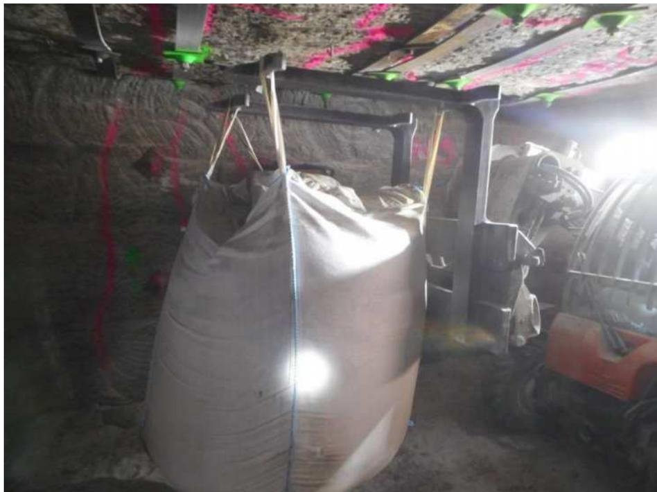
Figure 34 - Fourche inversée utilisée en 2015 pour l'extraction mécanique des big bag
