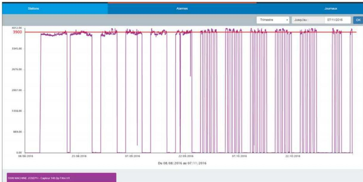
Figure 41 - Relevés de pression - Bloc filtre H11
