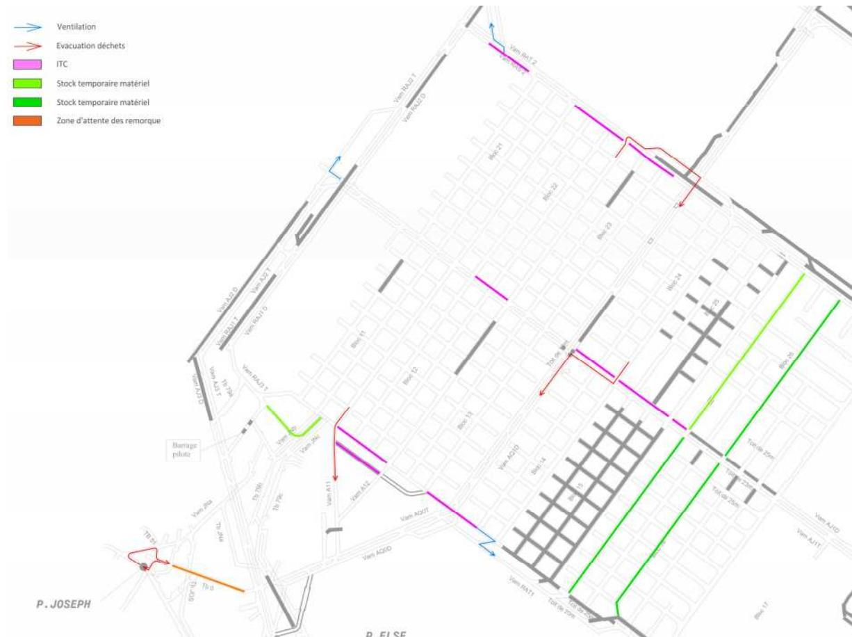
Figure 23 - Plan des ITC et circulations pour la phase 1 du scénario S3
