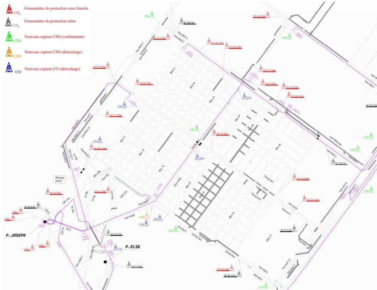
Figure 22 - Plan de localisation des nouveaux capteurs de surveillance
