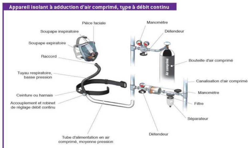
Figure 7 : Schéma d'alimentation d'un masque à partir du réseau Air Comprimé
