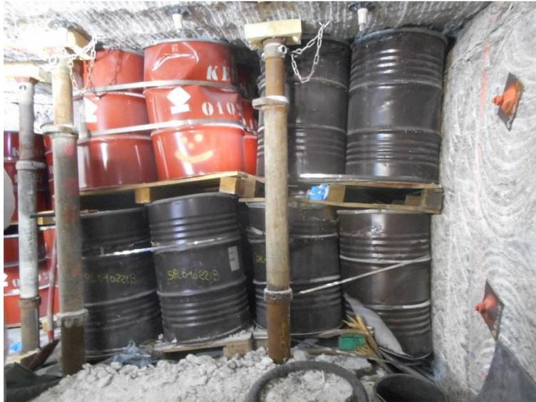
Figure 24 : Exemple de fûts déformés par la convergence des terrains
