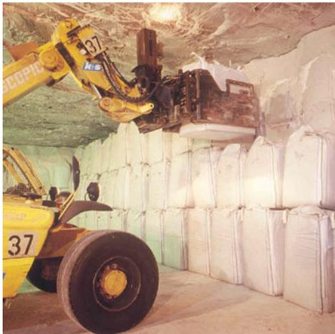
Fig. 4.3 : Prise des big-bags avec un engin équipé de pince (p.ex. dans la mine Herfa-Neurode en Allemagne).
