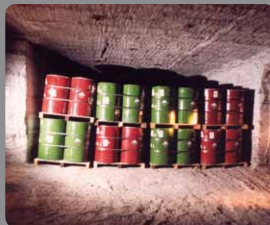
Le conditionnement des déchets : « big-bags » et fûts métalliques
