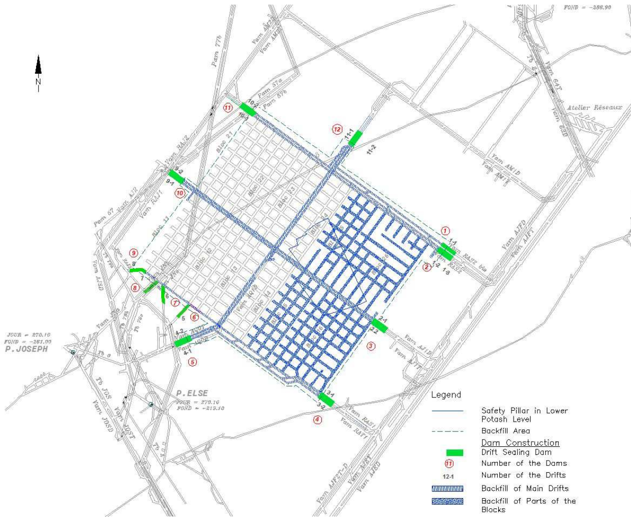
Figure 5 Aperçu de l'emplacement des sites des barrières prévus ainsi que des galeries principales et des vides à remblayer dans les blocs de stockage
